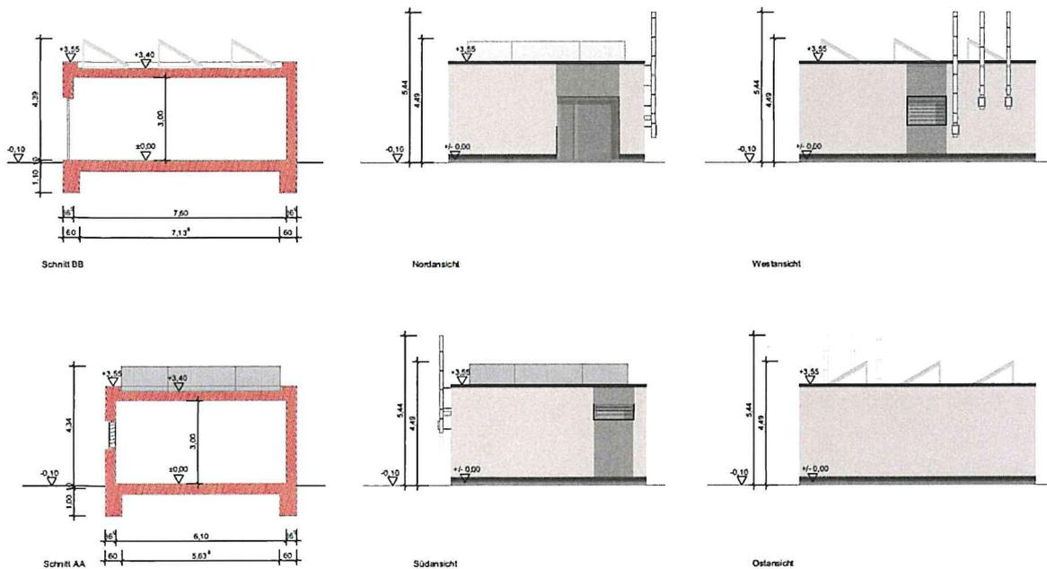
Abbildung 5.3 Schnitte der geplanten Heizzentrale (Auszug aus Bauantrag Ansichten)
