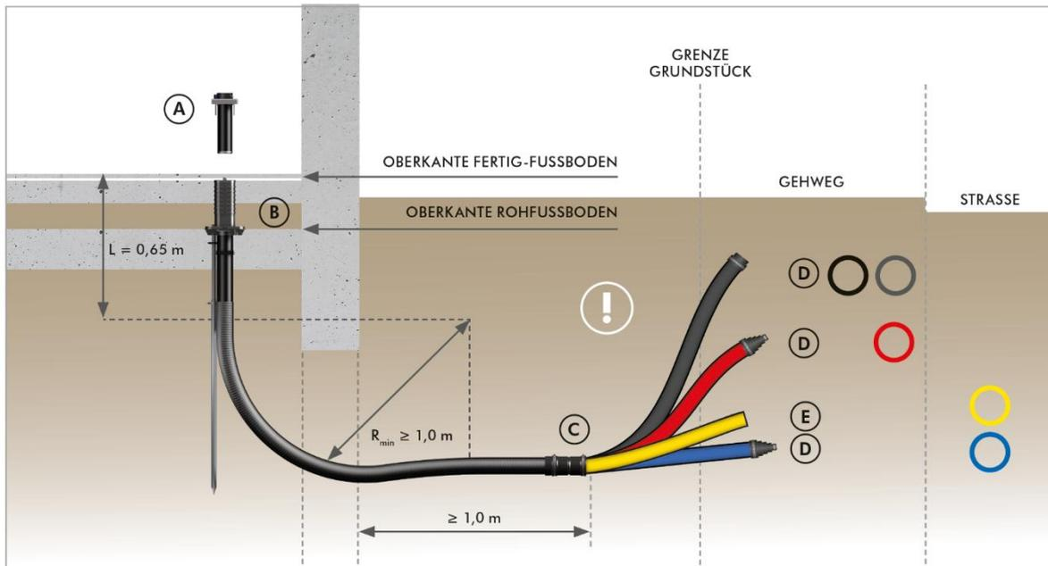
Installationsteil: Quadro-Sicura® Nova R4-I / Rohbauteil: Quadro-Sicura® Nova R4-R
